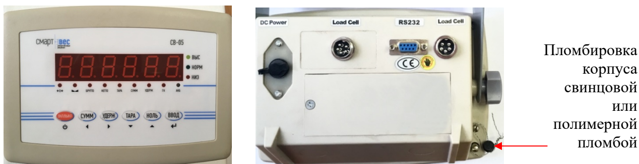
Рисунок 2 — Внешний вид и схема пломбирования весоизмерительного прибора СВ-05
