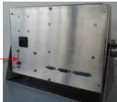
Рисунок 4 — Общий вид и схема пломбировки прибора весоизмерительного ЭТД-01 (пример)
