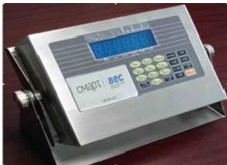
Пломбировка корпуса (предотвращение доступа к переключателю режима регулировки)
