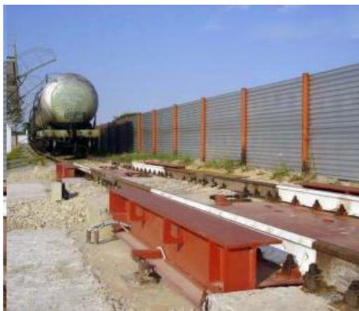
Весы железнодорожные для сжиженного газа предназначены для взвешивания цистерн для перевозки природного газа, нефтепродуктов, химических веществ. Взвешивание осуществляется в статическом режиме повагонно с выводом информации на компьютер или цифровой индикатор.
